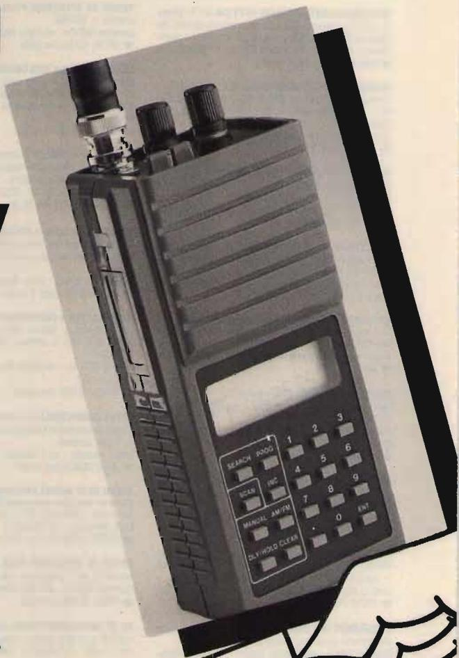
Il ricevitore di grande praticità, molto compatto e di minime dimensioni, permette il controllo di una vasta gamma dello spettro; ideale per l'ascolto delle Forze dell'ordine pubblico (FM), Aeronautica civile (in AM) e dell'attività radiantistica in VHF/UHF. Durante la ricerca, entro dei limiti impostati, si potrà registrare in memoria le frequenze di interesse e successivamente procedere con una ricerca entro le memorie così registrate.
